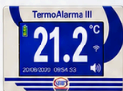
PANTALLA PRINCIPAL Supervisa la temperatura en tiempo real.
